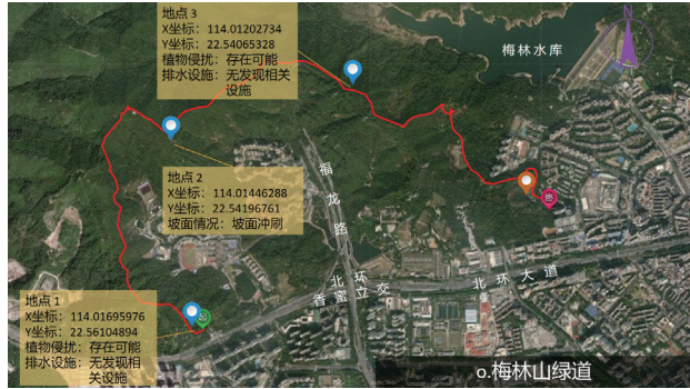
注：图中红色直线表示调研路段，蓝色标记点表示在植物侵扰、坡面情况以及防排水设施方面存在问题的调研点，橙色标记点表示没有出现上述问题的其他调研点。 图1 各绿道调研点情况 (g~p) Fig.1 Status of each greenway in research sites (g~p)
